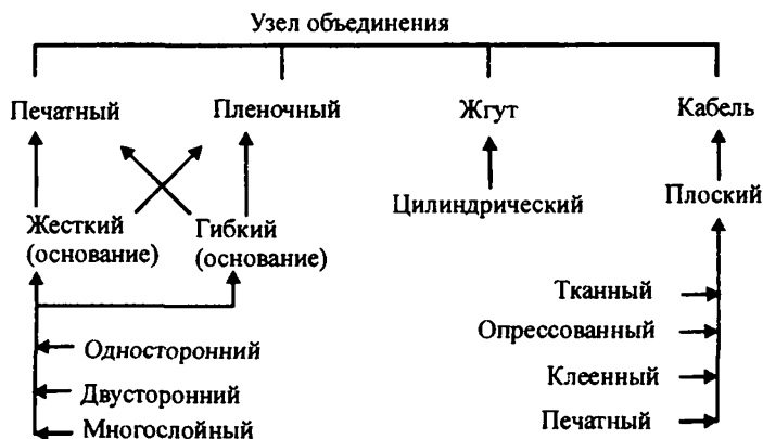
Рис. 5.2. Конструктивно-технологическое объединение линий передач
