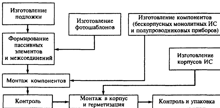
Рис. 7.2. Укрупненная схема ТП изготовления гибридно-пленочных МС
