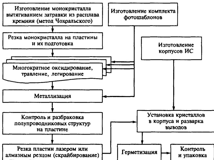
Рис. 7.1. Укрупненная схема ТП изготовления полупроводниковых (монолитных) ИМС
